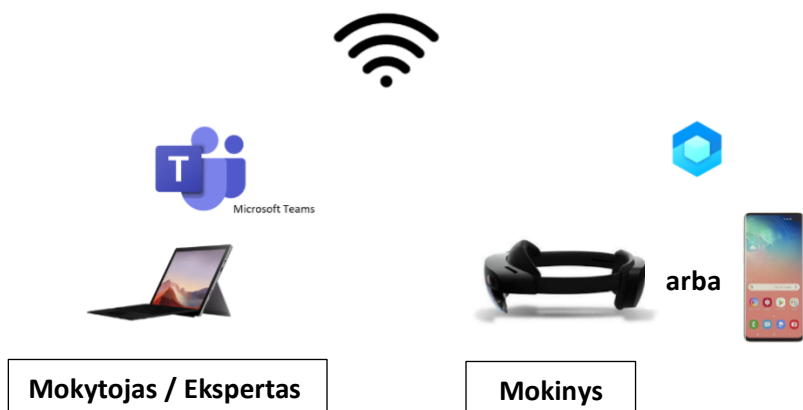
3 pav. Papildytos realybės nuotolinio palaikymo techninė ir programinė įranga
